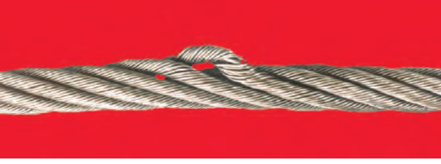
a. Damar çıkması ya da bükülmesi
