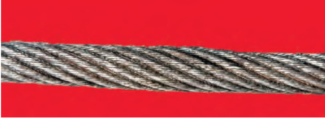
l. Öz hasarlanmasından dolayı çaptaki lokal artışlar
