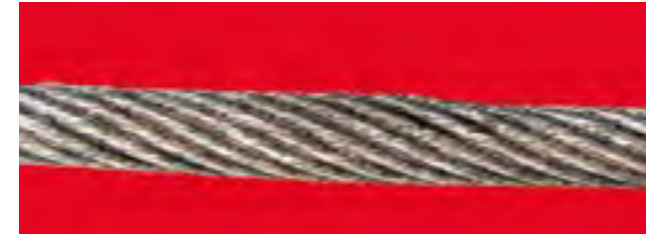
l. Öz hasarlanmasından dolayı çaptaki lokal artışlar
