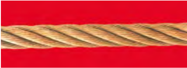
h. Dış korozyon
